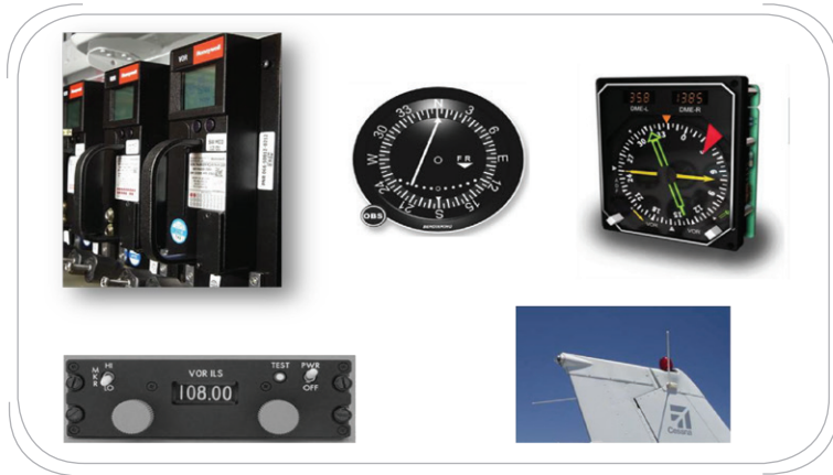
شکل ۲-۲۰ اجزای سیستم VOR در هواگرد
