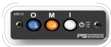
شکل ۲-۳۱ نمایشگر Marker Beacon در کابین پرواز
