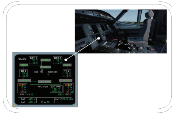
شکل ۲-۸۴ نمایش شاخص های الکتریکی در A320
