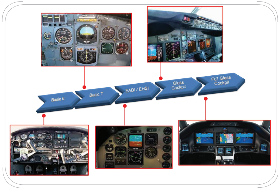
شکل ۲-۱۲۸ سیر تکامل تکنیک‌های نمایش در آلات دقیق
