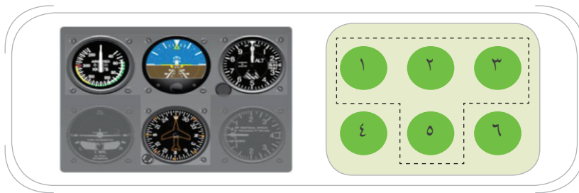
شکل ۲-۱۲۷ چیدمانی به صورت Basic T
