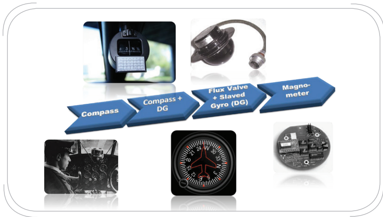
شکل ۲-۱۱۶ سیر تکامل اندازه‌گیری HDG
